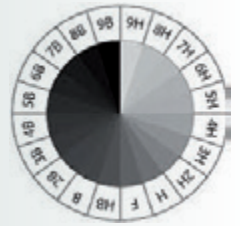
Representación circular de los valores de la mina según su dureza (9H-9B).
